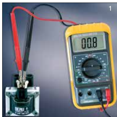
Test resistenza primaria
