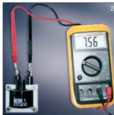
Test resistenza secondaria
