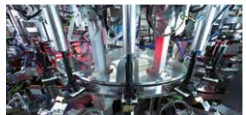
Uno dei passaggi più importanti della sequenza di produzione: il controllo finale della bobina d'accensione.
