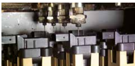
Wtórny drut został osadzony w odlanej żywicy przy użyciu odlewania próżniowego.
