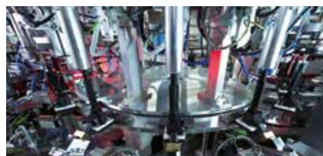
Jeden z ważniejszych etapów w procesie produkcji: ostateczna kontrola cewki zapłonowej.
