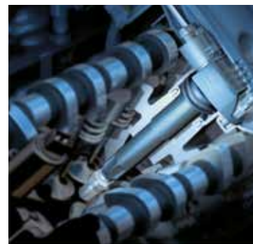
Świecowe cewki zapłonowe są montowane głęboko w komorze silnika i muszą wytrzymać bardzo duże obciążenia termiczne.
