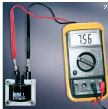
Sprawdzenie oporności wtórnej
