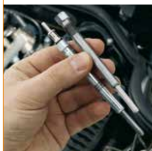
El escariador BERU: (RA003 - 0 890 100 003) suelta la carbonización que se pueda producir tras el calentamiento entre el calentador y la culata.
