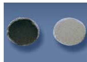
Depósitos de carbonilla en el papel filtrante tres minutos después del arranque en frío. Con la incandescencia posterior (derecha), los depósitos de carbonilla son aproximadamente un 40% menores que sin esta tecnología.
